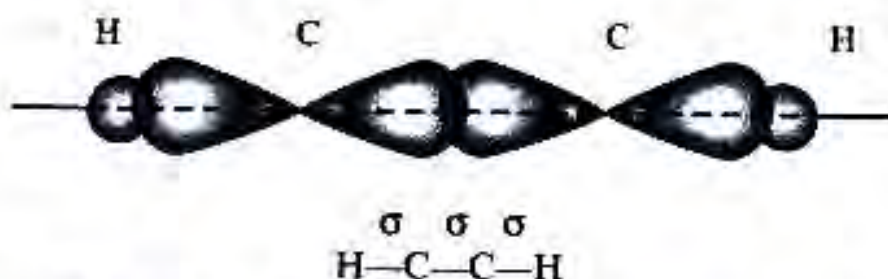
Расми 12. Нақшаи ҳосилшавии \sigma -бандҳо дар молекулаи атсетилен
