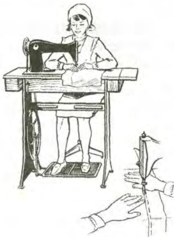
Расми 33 Мошини дарздӯзи пойӣ 1 – чархи гардона 2 – тана 3 – тасма 4 – асос 5 – чархи ҳаракатдиҳанда 6 – сипарча 7 – педал
