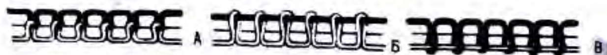
Расми 45. Дурусти чок: а – чоки дуруст; б – чоки нуқсондор (ресмони поён халта); в – чоки нуқсондор (ресмони боло халта)
