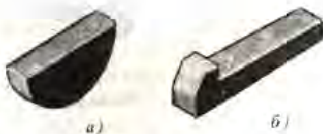
Расми 225. Навъҳои гуваҳо: а - гуваи сегментӣ, б - гуваи фонашакл.
