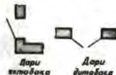
Расми 244. Ишоратҳои шартӣи ҷойҳои дару тирезаҳо.
