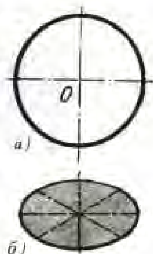
Расми 251. Табдили нақша: а – нақшаи аввал, б – нақшаи фишурдашуда (эллипс – фишурдаи давра).
